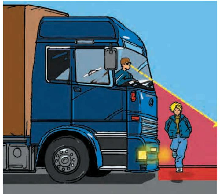
Alles, was sich im toten Winkel befindet, ist für den Fahrzeugführer nicht sichtbar.
